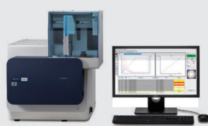
使用熱脫附質譜儀 (TD-GC/MS) 檢驗塑化劑
