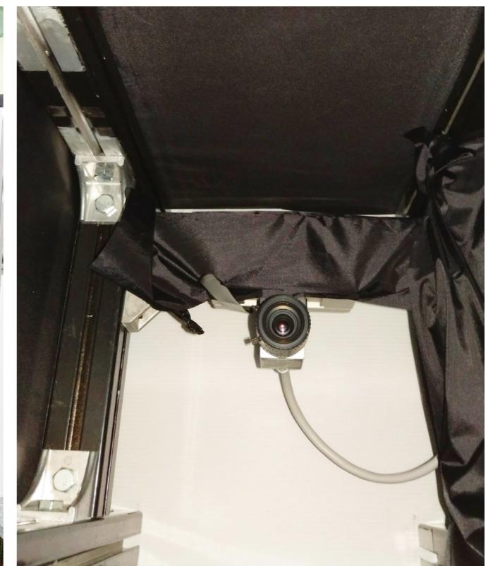
自舊治具拆下 CCD 相機模組，100% 應用在新專案，重新設計成新設備
