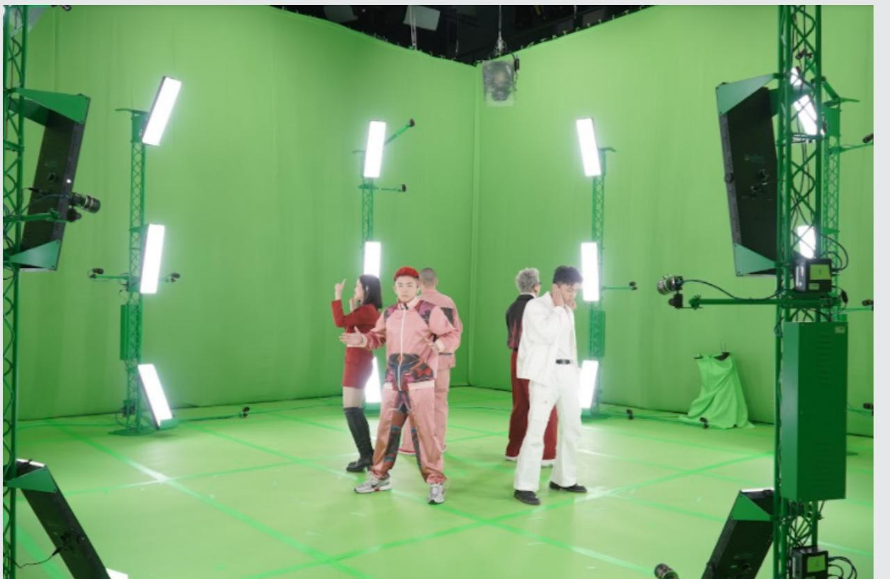
4D Views 容積攝影棚可拍下 360 度零死角的 3D 畫面，並在後製過程確保實體與虛擬空間的完美結合。
