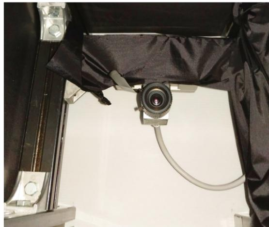
自舊治具拆下 CCD 相機模組，100% 應用在新專案，重新設計成新設備。
