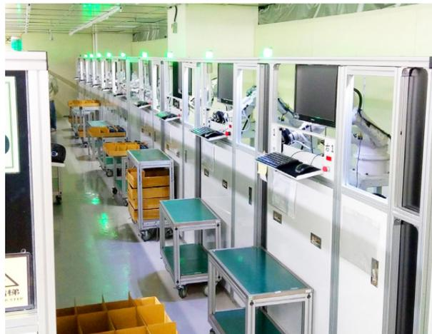
將舊專案站體拆解後的鋁擠條與可重複利用的材料，重新組成新專案站體
