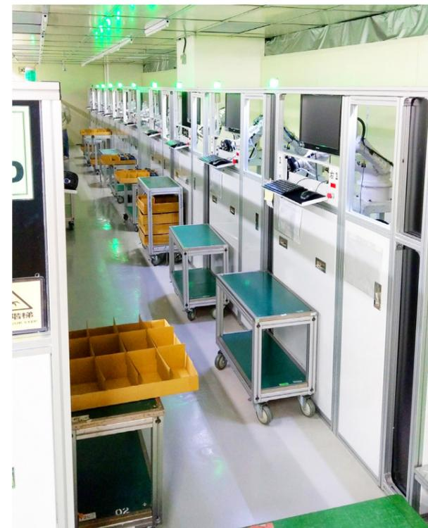
將舊專案站體拆解後的鋁擠材與可重複利用的材料重組成專案站體
